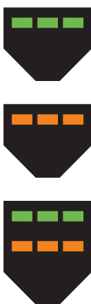
Układy barw latarni pasa świetlnego
